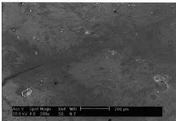
Figura 32: Foto ampliada em 200x da liga Fe30Al10Ti após ensaio a 800°C sob atmosfera de Ar.
