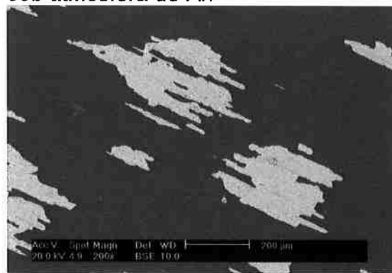
Figura 35: Foto ampliada em 200x da liga Fe30Al6Cr após ensaio a 900°C sob atmosfera de Ar.
